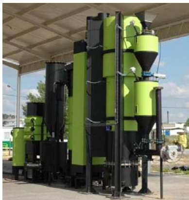
Figura 1: Unidade Piloto de gaseificação térmica de biomassa em leito fluidizado do Instituto Politécnico de Portalegre, Portalegre, Portugal.
