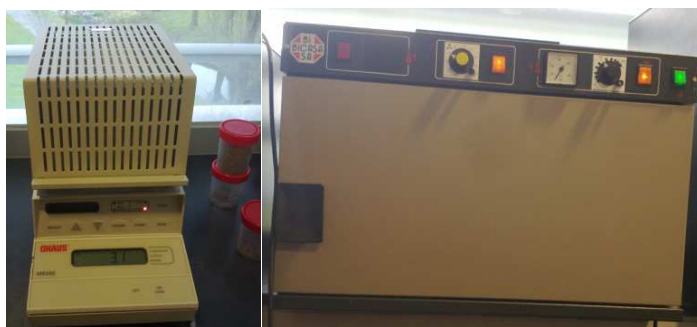
Figura 2: a) Balança aquecida (OHAUS - MB200) e b) Estufa de temperatura controlada para ensaios de Determinação de Teor de Húmda de Biomassas no Laboratório de Química da ESTG, Instituto Politécnico de Portalegre, Portalegre, Portugal.
