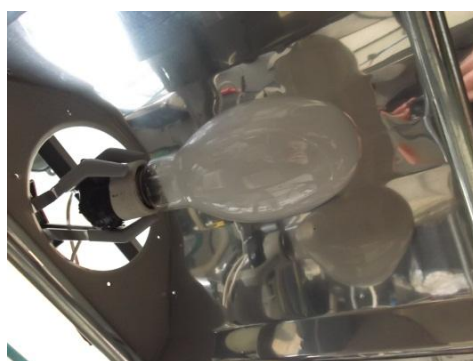
Figura 1 Lâmpada de vapor de mercúrio de 125 W instalada no interior da campânula de interior espelhado.
