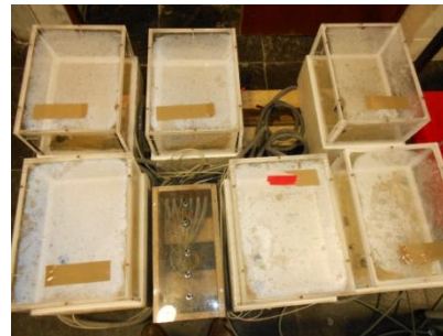
Fotografia 6 – Provetes 7 a 12 - armadura pintada e armadura sem proteção.
