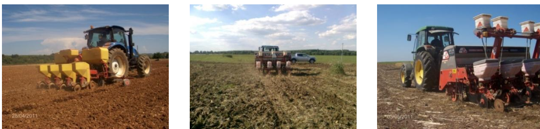
Fig. 1. Operações de sementeira e máquinas utilizadas em cada uma das parcelas (da esquerda para a direita): sementeira em mobilização convencional (Pigeiro), sementeira em mobilização mínima (Comenda) e sementeira direta (Lages).
