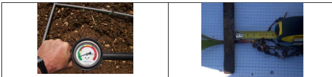
Fig. 2. Mostrador do penetrómetro de cone para determinação da resistência mecânica do solo ao rompimento (à esquerda) e determinação da profundidade de sementeira pela avaliação do comprimento do mesocótilo de plantas de milho pós emergência.
