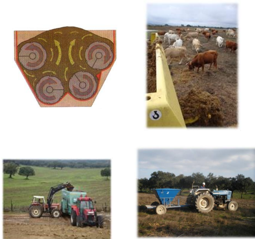
Figura 2 – Distribuição mecanizada dos alimentos em campo: esquema cinemático de funcionamento dos órgãos de mistura de um semi-reboque unifeed (em cima à esquerda), operação de distribuição de dietas em cordão no solo (em cima à direita), operação de carregamento de um semi-reboque unifeed (em baixo à esquerda) e distribuição de forragem em tacos (em baixo à direita).
